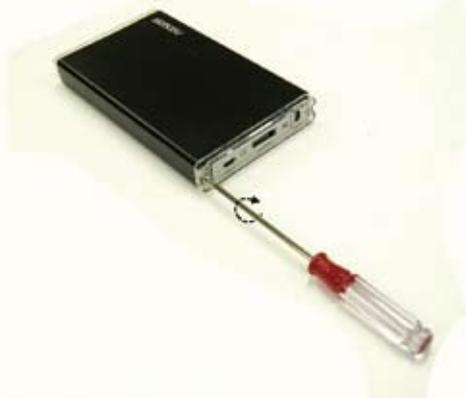
2箇所を付属のプラスドライバーで外します。
