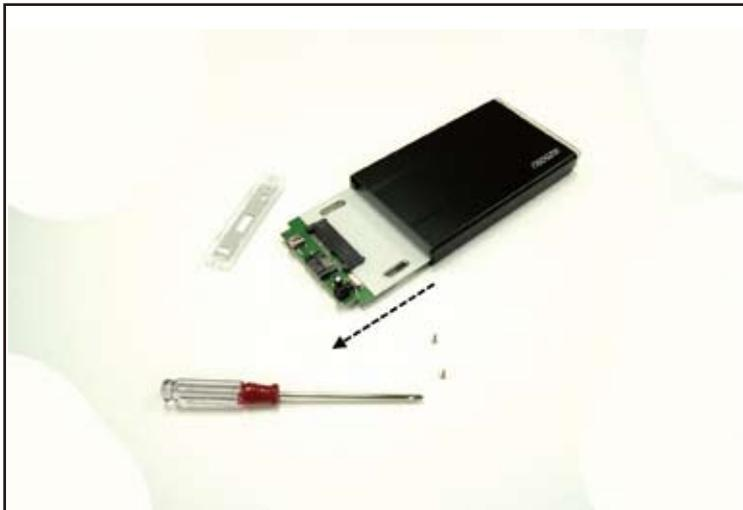
パネルを外したら基板を引き出します。
